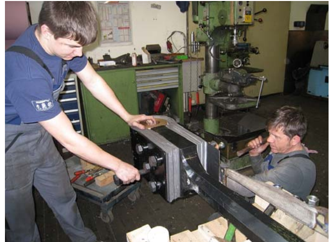
Abb. 11: Innsbruck, Erneuerung der Klöppeleinbindung (Photo: Grassmayr).
