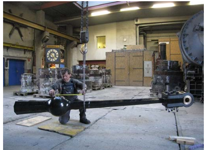
Abb. 12: Innsbruck, Prüfung des Klöppelschwerpunktes (Photo: Grassmayr).
