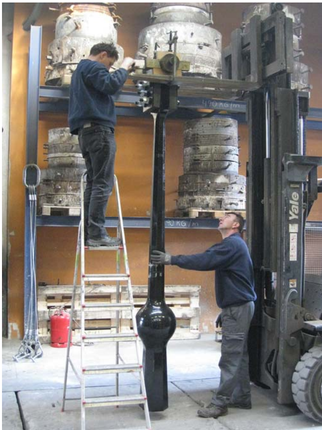
Abb. 13: Innsbruck, Prüfung der Pendelfrequenz des Klöppels (Photo: Grassmayr)
