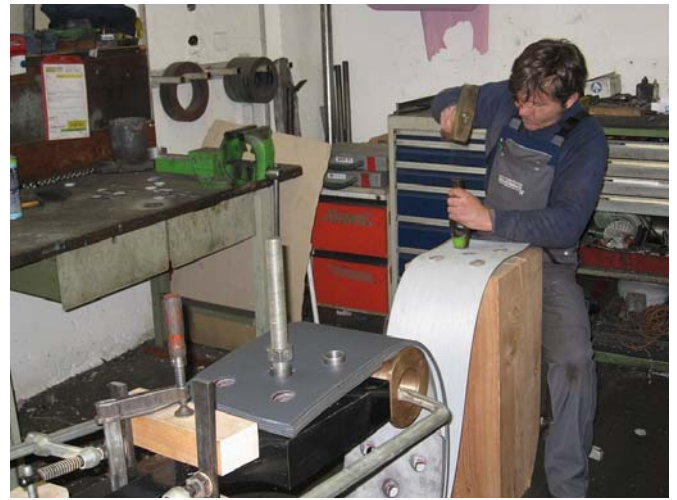
Abb. 10: Innsbruck, Erneuerung der Klöppeleinbindung (Photo: Grassmayr).
