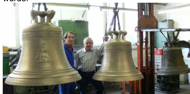
Abb. 9: Innsbruck, Kollaudierung der zwei neuen Glocken mit transponierten Rippen in Abstimmung mit der historischen Glocke von Grosze für Leipzig Engelsdorf durch die Glockensachverständigen Dipl.-Ing. Roy Kreß und Uhrmachermeister Rudolf Friedrich Meinhardt (*1935 +2010)
