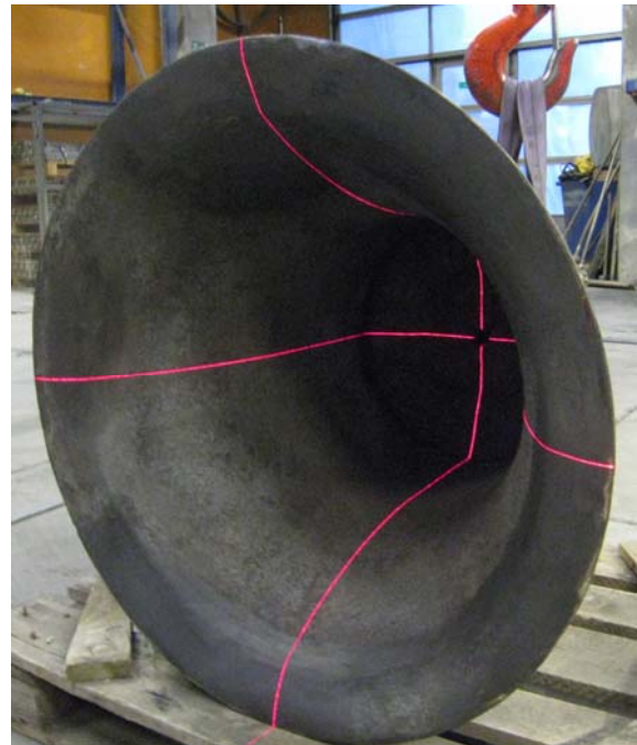
Abb. 5: Laservermessung der Glocke des Gießers GROSZE in Leipzig-Engelsdorf in der Glockengießerei GRASSMAYR in Innsbruck. 1
